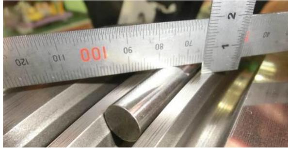
図 2-1: 溝摩耗の測定方法
