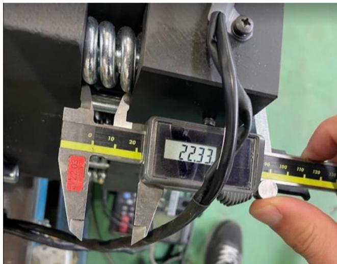
d寸法はエアギャップを0.3~0.4mmに調整されていることを確認後、写真の様に測定してください
