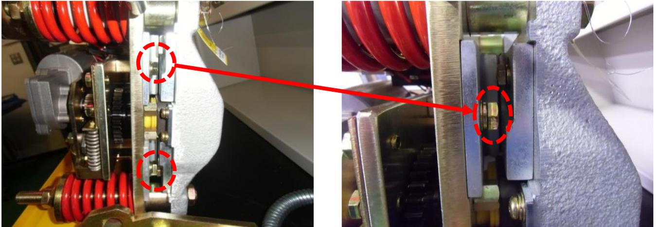
図 11-2: ブレーキパッド固定ボルト (M8)
